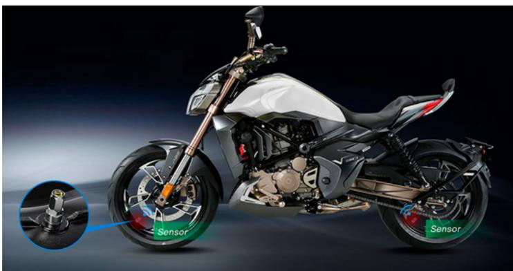
A motocicleta possui **chips de monitoramento de alta precisão**. Quando a pressão dos pneus é anormal, ele indica um aviso no painel de instrumentos.
