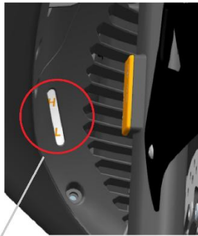
Observe o indicador de nível de líquido do tanque r eservatório
