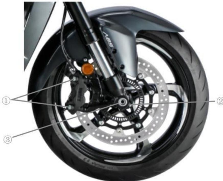
Torque do eixo dianteiro 65 N.m
