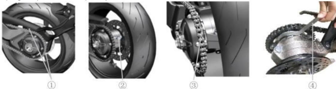
Passo 1: Use a chave Allen n.º 6 para remover o parafuso M8 como ilustrado e remova cuidadosamente o para-choques traseiro, tendo cuidado para não puxar o fio.
