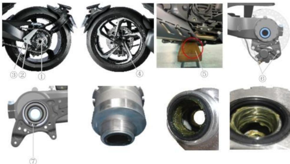
Passo 1: Remova a mola de bloqueio presa no eixo traseiro e, em seguida, use um torquímetro de 200 N e um soquete padrão de 12 ângulos métricos de 42 mm, o modelo Stanley é 89-642-1-22 para soltar a porca M35. Aperte o pedal do freio para evitar que a moto rode. Tenha cuidado para não remover completamente a porca M35.
