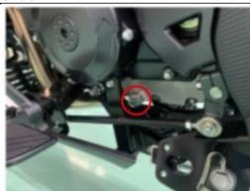
Parafuso de drenagem de óleo do motor
