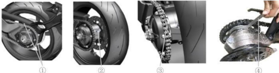
Passo 1: Use a chave Allen n.º 6 para remover o parafuso M8 como ilustrado e remova cuidadosamente o para-choques traseiro, tendo cuidado para não puxar o fio.
