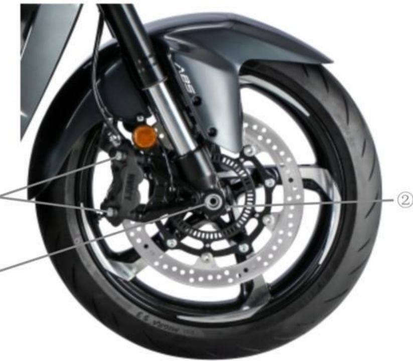
Torque do eixo dianteiro 65 N.m
