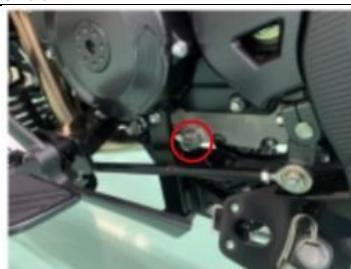
Parafuso de drenagem de óleo do motor
