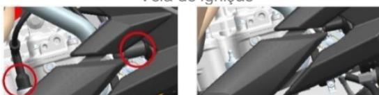
Desmontar a vela de ignição
