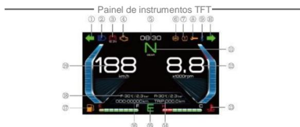
O painel de instrumentos é composto por quatro interfaces diferentes, com versões de lazer, corrida, street e simplicidade, respectivamente. A interface pode ser selecionada de acordo com a preferência do condutor. Na figura abaixo você poderá encontrar uma breve descrição do painel de instrumentos com a interface de lazer selecionada.
