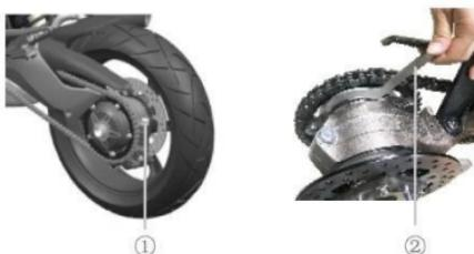
Passo 1: Solte o parafuso M16x1.5 mostrado na imagem com uma chave de torque a de 100 N e o sextavado 21# externo. Não é necessário que fique completamente desparafusado.
