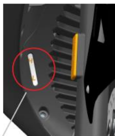
Observe o indicador de nível de líquido do tanque reservatório
