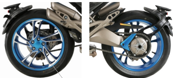
M12x1.5 porca Porca da Roda Traseira. Torquímetro: 110N.m
