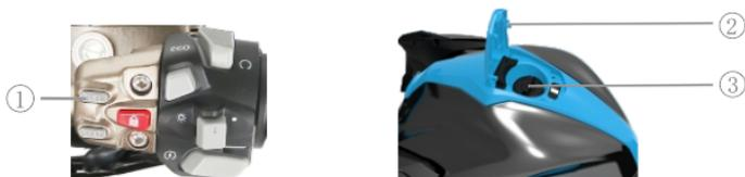
O tanque de combustível está localizado dentro da tampa do tanque de combustível, na parte da frente do assento. Ao abrir a tampa do tanque de combustível, confirme que o motor está desligado, e pressione o botão do tanque de combustível (em 1), a tampa do depósito (em 2) irá abrir automaticamente, gire a tampa (em 3) no sentido anti-horário. Para colocar a tampa, gire no sentido oposto, sentido horário.
