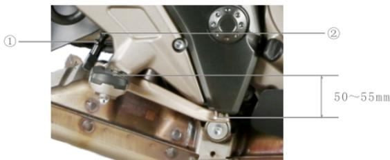
1. Solte a porca ① e o parafuso ②, a posição do pedal de freio em relação ao topo do pé deve estar entre 50 a 55 mm.
