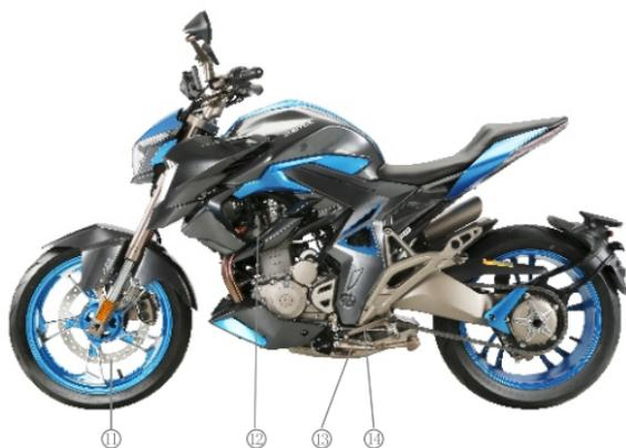
⑧ Disco de Freio Traseiro ⑩ Pedal de Freio Traseiro ⑫ Bobina de Ignição ⑭ Polo de Mudança de Marcha
