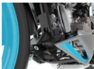
66. Reinstale usando um parafuso de drenagem e uma anilha. (Aperto com a chave dinamométrica deve ser 24±4N.m);
