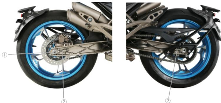
Porca da Roda Traseira. Torquímetro: 110N.m
