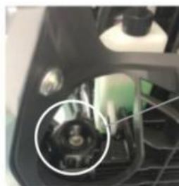
Tampa do depósito de água
