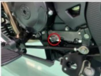
Parafuso de drenagem de óleo do motor
