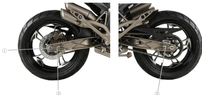
Porca da Roda Traseira. Torquímetro: 110N.
