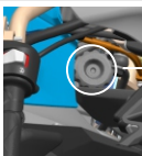
Cobertura do tanque de água
