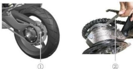
Passo 1: Solte o parafuso M16x1,5 mostrado na imagem com uma chave de torque a de 100 N e o sextavado 21# externo. Não é necessário que fique completamente desparafusado.
