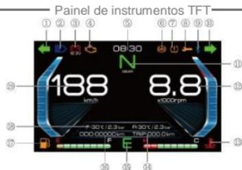
O painel de instrumentos é composto por quatro interfaces diferentes, com versões de lazer, corrida, street e simplicidade, respectivamente. A interface pode ser selecionada de acordo com a preferência do condutor. Na figura abaixo você poderá encontrar uma breve descrição do painel de instrumentos com a interface de lazer selecionada.
