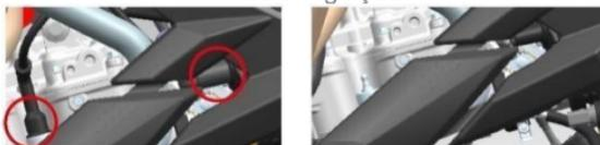
Desmontar a vela de ignição
