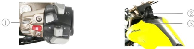
O tanque de combustível está localizado dentro da tampa do tanque de combustível, na parte da frente do assento. Ao abrir a tampa do tanque de combustível, confirme que o motor está desligado, e pressione o botão do tanque de combustível (em 1), a tampa do depósito (em 2) irá abrir automaticamente, gire a tampa (em 3) no sentido anti-horário. Para colocar a tampa, gire no sentido oposto, sentido horário.
