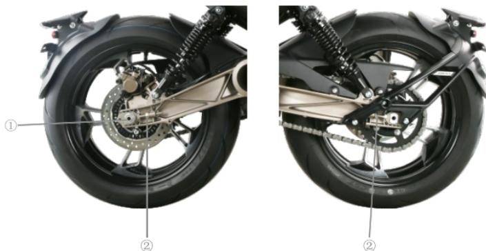
Porca da Roda Traseira. Torquímetro: 110N.m
