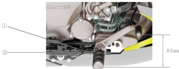
1. Solte a porca ① e o parafuso ②, a posição do pedal de freio em relação ao topo do pé deve estar entre 50 a 55 mm.
