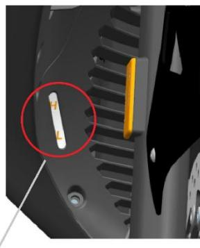
Observe o indicador de nível de líquido do tanque de reservatório
