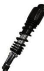
A força de pré-carga do amortecedor traseiro pode ser ajustada de acordo com o condutor, com as condições de carregamento de carga, com o estilo de condução e com as condições da estrada. Cinco mudanças podem ser ajustadas. Utilize ferramentas apropriadas para rodar o ajustador de pré-compressão para a posição desejada, ajuste o amortecedor para a direita para deixar o amortecedor mais rígido e para a esquerda para deixá-lo mais macio.
