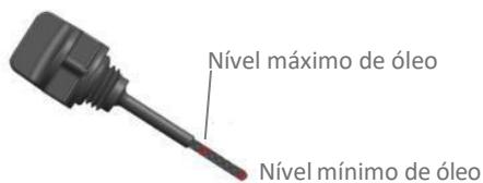
É fundamental utilizar um óleo de alta qualidade e trocar óleo com regularidade. A inspeção frequente do nível de óleo do motor e a substituição regular do óleo do motor e do filtro de óleo são duas tarefas importantes na manutenção do veículo.
