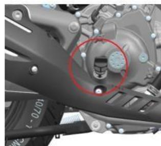
5. Instale o parafuso de drenagem, e a arruela, de óleo do motor e aperte o parafuso de drenagem de óleo conforme o torque de aperto especificado. (Torque de aperto: 25 N.m)
