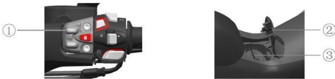
O tanque de combustível está localizado debaixo da tampa do tanque de combustível. Quando abrir a tampa do tanque de combustível, certifique-se de que o botão de parada do motor está desligado, pressione o botão do tanque de combustível ①, a tampa do tanque ② irá abrir-se automaticamente, pressione a tampa do tanque de combustível ③ para a esquerda. Ao colocar a tampa, siga os passos anteriores pela ordem inversa.
